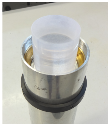
Obrázek 2.2: Plastikový scintilátor BC-408 v ToF detektoru.
